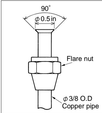
**CONNECTION OF COPPER PIPES**
